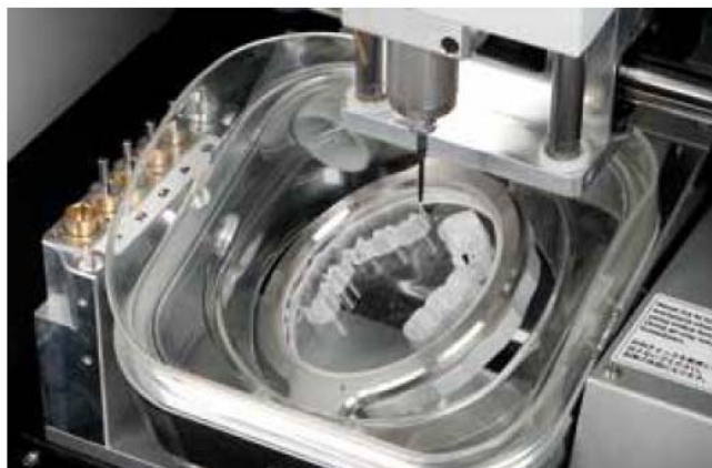
5-осевой станок 1 ( Roland DWX-50 для стоматологических применений).
